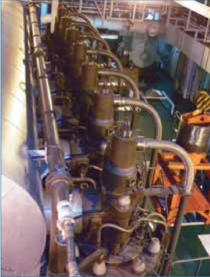
Auf dem Bild links schaut man von vorne über die sieben Zylinderköpfe nach achtern. Rechts von den Zylindern steht ein neuer Kolben, den man auf dem Bild rechts zusammen mit mir zum Größenvergleich nochmals sehen kann.
