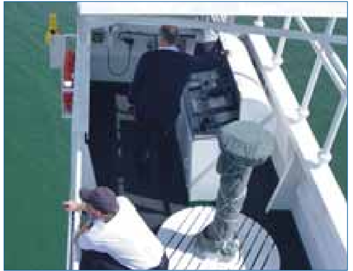
Blick von oben auf die Backbord-Brückennock mit dem Außen-Fahrstand. (von unten: Chief Mate, Kapitän, Lotse). Fahrtrichtung von links nach rechts.
